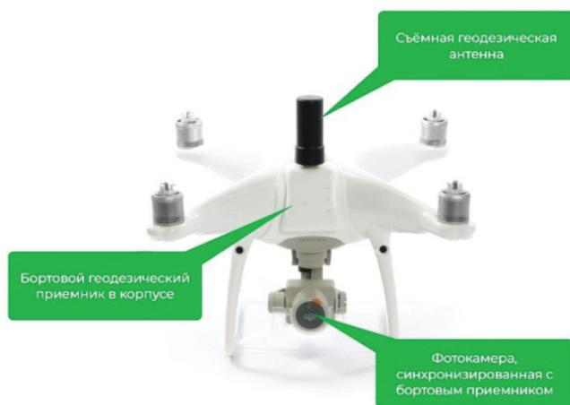
Рисунок 1 – Квадрокоптер DJI Phantom 4 Advanced с установленным на него высокоточным GNSS оборудованием EmlidReach RTK
