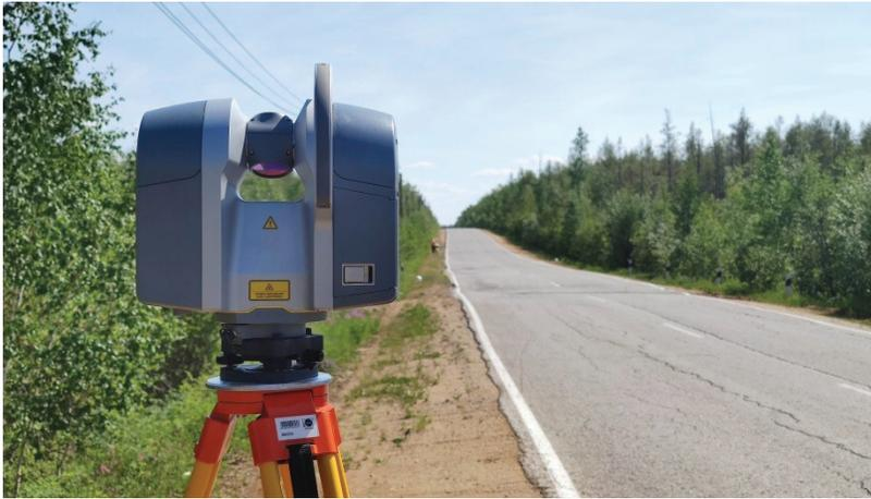
Рисунок 5 – Наземной лазерный сканер Trimble TX8 Extended
