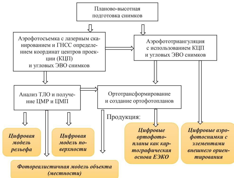
Рис. 2. Технология создания продукции с использованием лазерного сканирования
