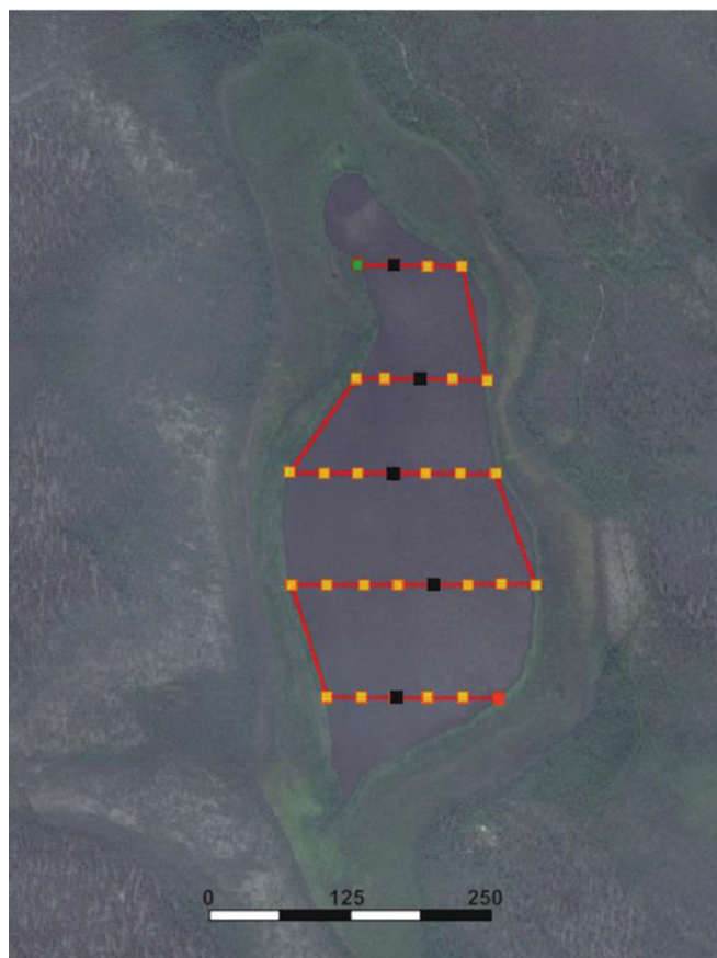
Рис. 1. Заложение поперечников и точек (скважин) для зондировки сапропелевых отложений.
