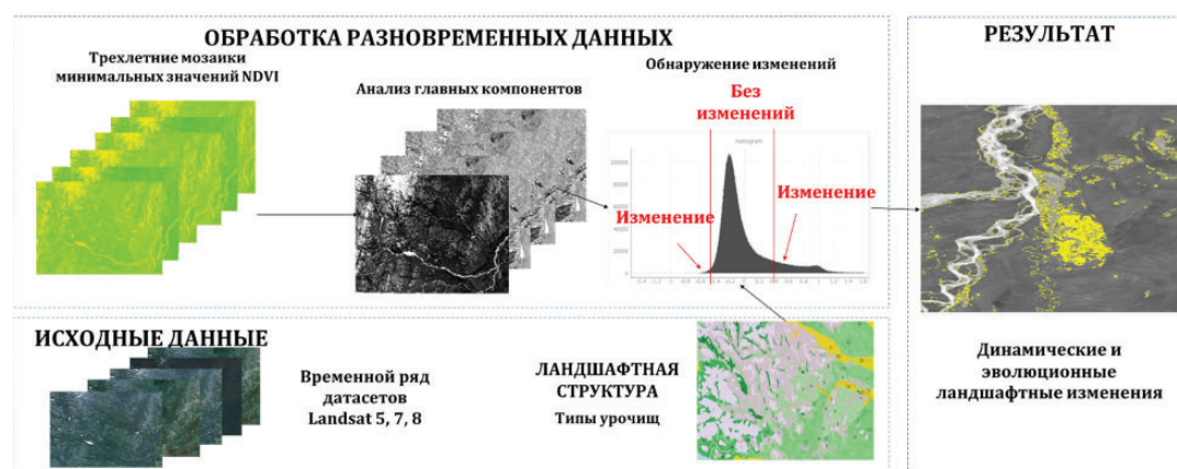
Рис. 2. Методологическая схема изучения ландшафтных изменений по анализу главных компонент
