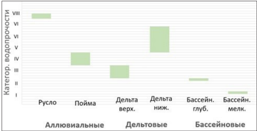
Рис. 4. Зависимость категории водопропрочности глинистых пород от фациальных условий
