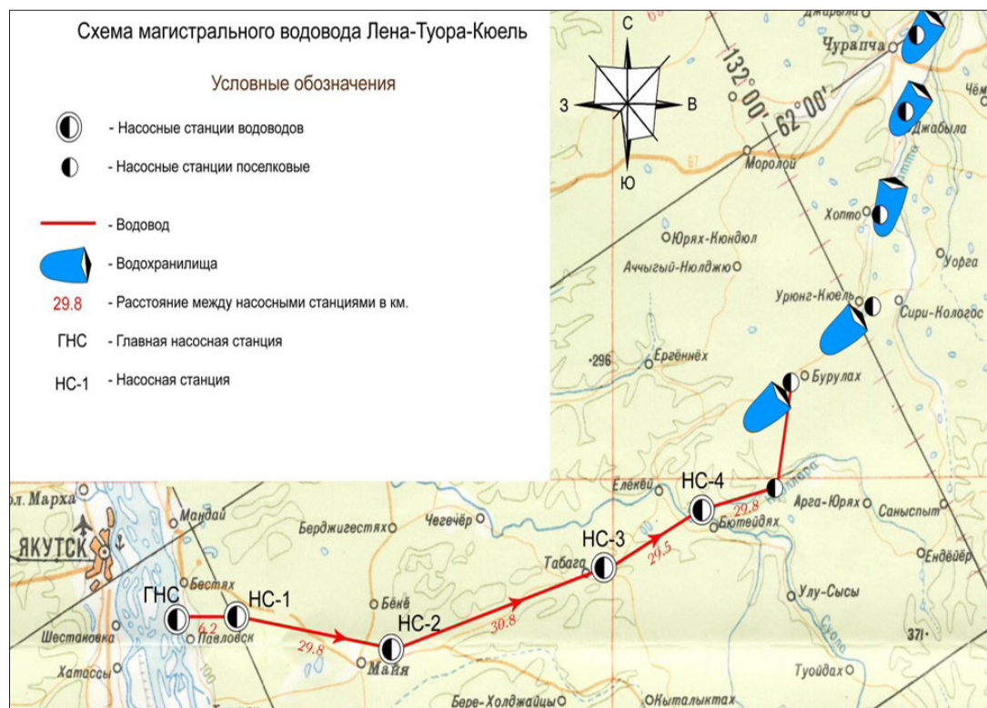
Рис. 1. Схема магистрального водовода Лена – Туора-Кюель
