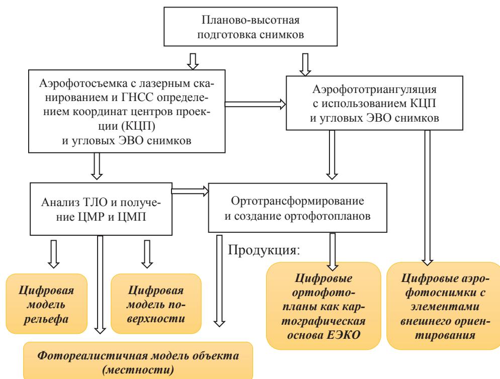
Рис. 2. Технология создания продукции с использованием лазерного сканирования
